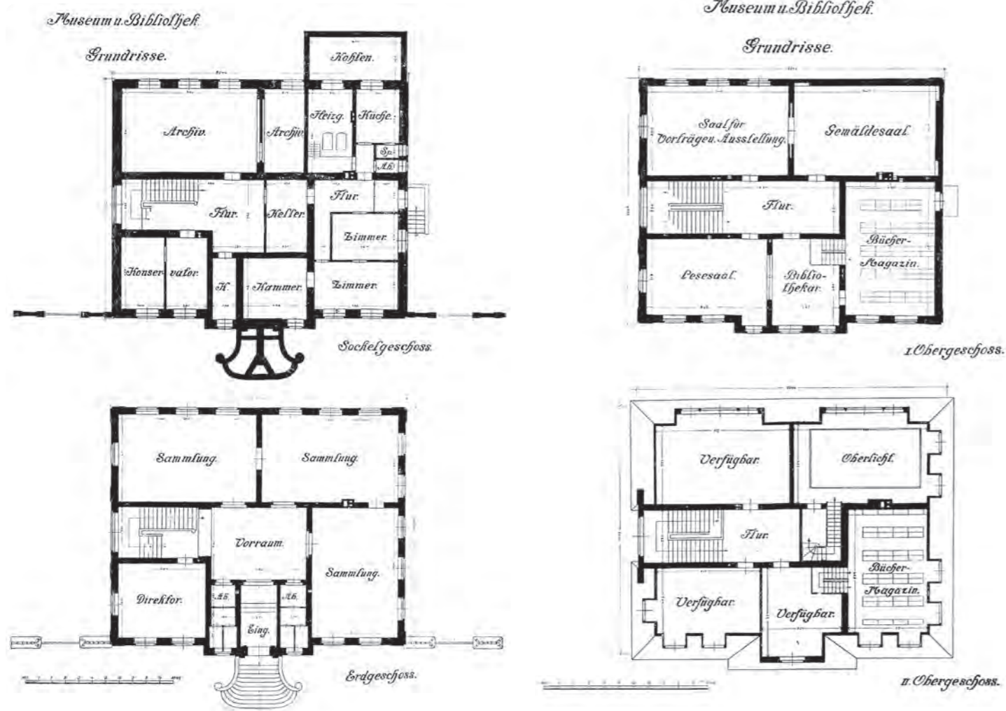
Rzuty pięter muzeum otwartego w 1912 r. Wystawa stała znajdowała się na parterze (Erdegeschoss) w trzech salach (Sammlung). Tam też znajdował się pokój dyrektora. Na pierwszym piętrze znajdowała się biblioteka z magazynem oraz czytelnia (Lesesaal, Bibliothekar, Bücher-magazin) oraz pomieszczenie na wystawy czasowe (Saal für Vorträge, Ausstellung) i malarskie (Gemäldeaal). Festschrift zur Eiweiung des Museums und der Stadtbibliothek in Graudenz. 24 Mai 1912, Graudenz 1912, s. 9–10 (nienumerowane).
